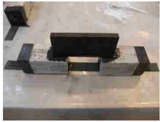
(d) Curing of epoxy composite under steel weight
